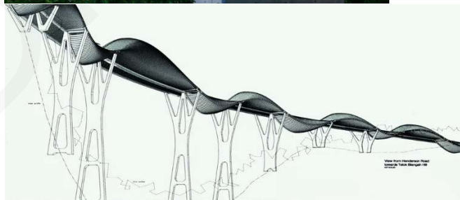
ภาพที่ 53 สะพานคนเดินที่ได้ชื่อว่าสวยที่สุด ( admiddleeast.com ) ใช้โครงสร้างแรงดึง (Catenary) คือสะพานเอนเดอร์สันเวฟ (Henderson Wave Bridge) ในสิงคโปร์
