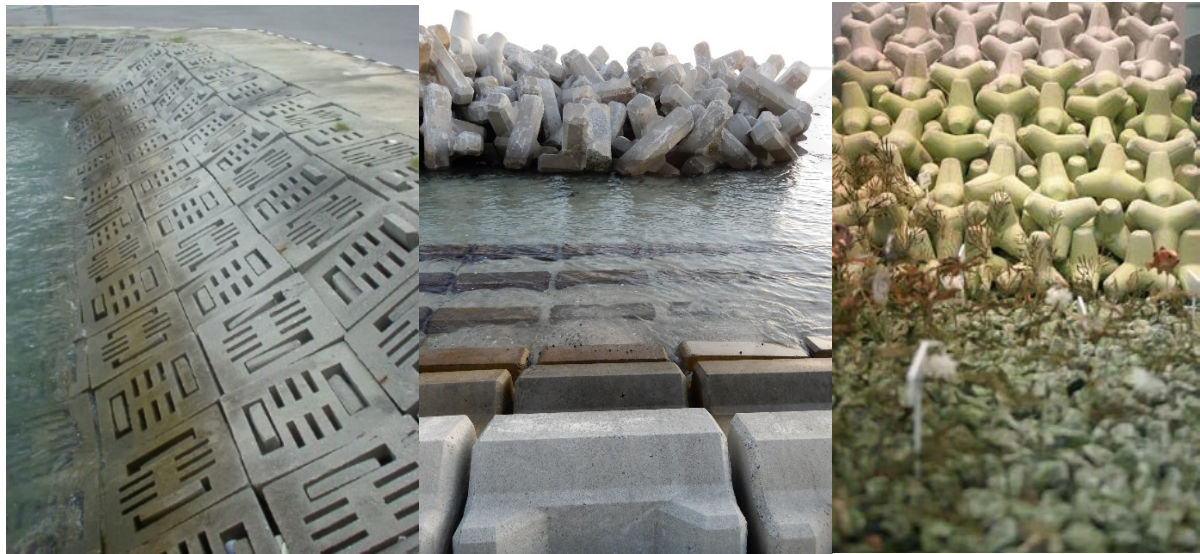
ภาพที่ 33 ก้อนคอนกรีตรูปทรงต่างๆ ที่ใช้ทำกำแพงกันคลื่น (Sea-wall) ในต่างประเทศ เหมาะกับการใช้กันคลื่นในมหาสมุทร มากกว่าชายหาดเลนแบบไทย
